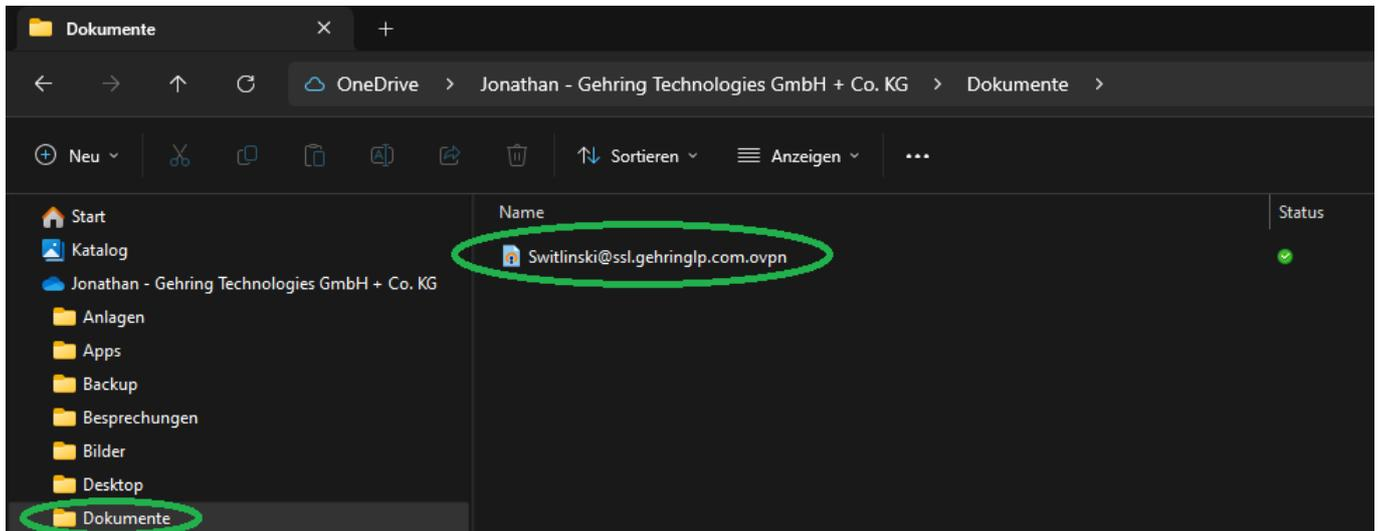
Das Ablegen der Konfigurationsdatei in den Dokumenten des OneDrives hat zwei Vorteile: Die Datei wird automatisch über OneDrive synchronisiert und gesichert und das Standard-Suchverzeichnis des OpenVPN Connect (VPN-Client) sucht später nach der Datei in diesem Verzeichnis.
